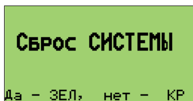
Рис. 58. Запрос на подтверждение сброса системы
