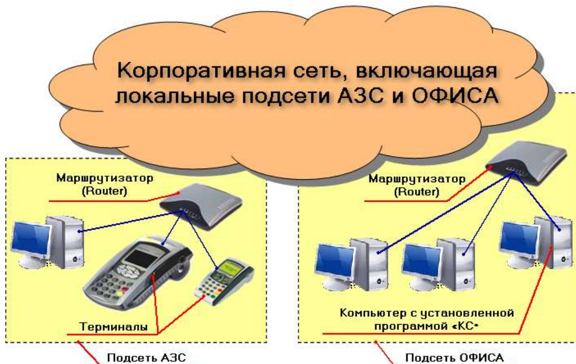
Рис. 2. Логическая схема передачи данных при инкассации по LAN
