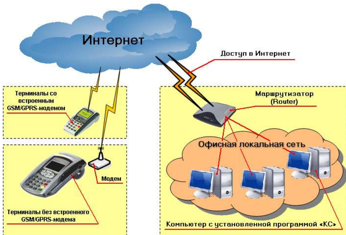
Рис. 1. Логическая схема передачи данных при инкассации по GPRS
